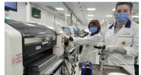
Catherine Cossard (à gauche) et Joëlle Chauvet (à droite) sont agents techniques de fabrication sur le site Atlantic de La Roche-sur-Yon. Les composants utilisés dans la fabrication des cartes électroniques sont dans des bobines, rangées dans un magasin.
