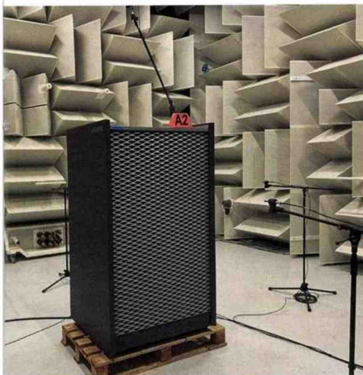
La chambre acoustique anéchoïque.
